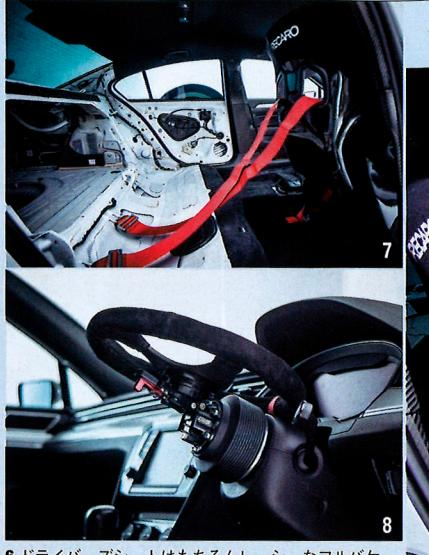
6.ドライバーズシートはもちろんレーシーなフルバケット。頭部を守るプロテクション付きのレカロ・プロレーサーSP-G。シュロスのハーネスがよく似合う 7.リアシートやドアパネルは撤去されているが、フロアカーペットなどはそのまま残された。ロールケージが入ればさらに雰囲気は上がりそう 8.ステアリングはATCの小径を跳ね上げ式のボスで装着している
