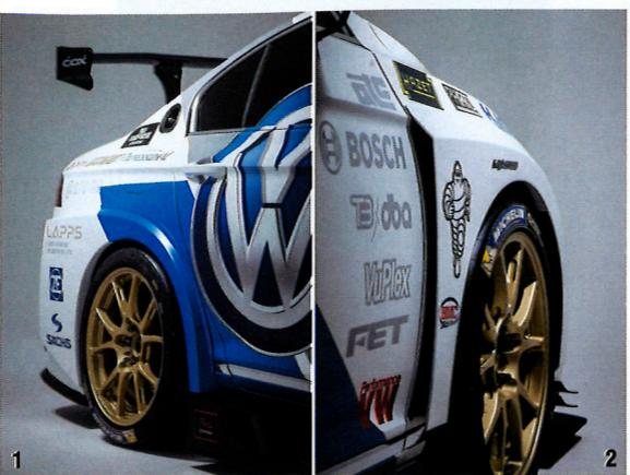
1.2.フロントフェンダーはプレスラインをトレースしてワイド化。リアはフェンダーアーチに沿ってサイドスカートから立ち上がりそのままオーバーハングまで抜けていく現代のレーシングカーの多くが用いるデザイン。後方にはスリットを設けて、よりレーシーなイメージを掲げている
