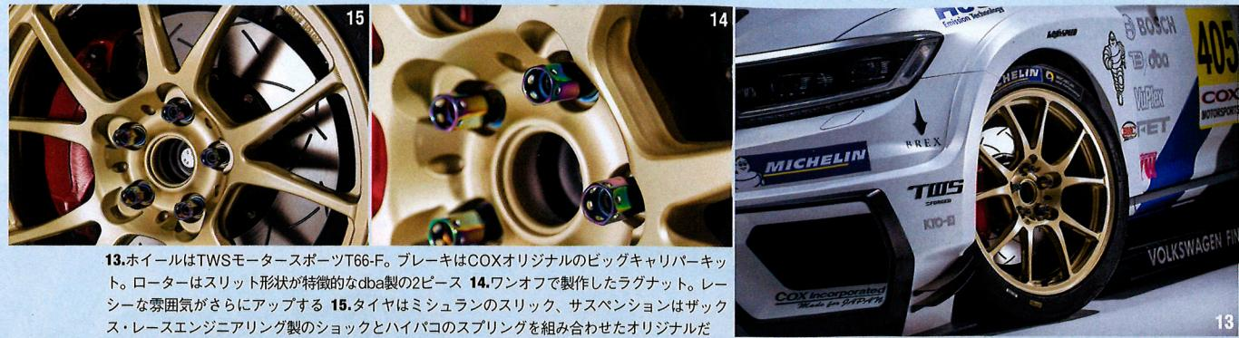
13.ホイールはTWSモータースポーツT66-F。ブレーキはCOXオリジナルのビッグキャリパーキット。ローターはスリット形状が特徴的なdba製の2ピース14.ワンオフで製作したラグナット。レーシーな雰囲気がさらにアップする 15.タイヤはミシュランのスリック、サスペンションはザックス・レースエンジニアリング製のショックとハイパコのスプリングを組み合わせたオリジナルだ
